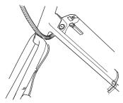
Paso 6. Instale la rueda delantera. Retire el inserto de plástico de la puntera de la horquilla.
