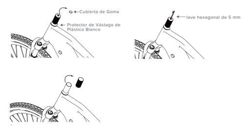
B. Coloque el vástago del manubrio sobre el vástago con la pantalla hacia arriba, vuelva a colocar la tapa superior y use una llave hexagonal de 5 mm para asegurar el vástago del manubrio.
