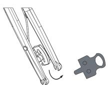
C. Instale con cuidado la rueda delantera y asegúrese de que el rotor del freno se asiente entre las pastillas de freno en la pinza de freno; la arandela plana del eje debe asentarse fuera de la puntera de la horquilla.
