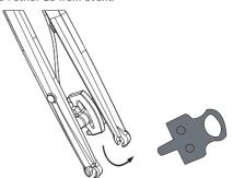
C. Installez soigneusement la roue avant et assurez-vous que le rotor de frein se trouve entre les plaquettes de frein dans l'étrier de frein; la rondelle plate sur l'axe doit se trouver à l'extérieur de la patte de fourche.
