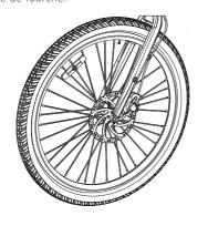
**Mise en garde:** Ne touchez jamais le rotor du frein, en particulier lorsque la roue et/ou le vélo est en mouvement, sous peine de vous blesser gravement. Les huiles à main peuvent provoquer des grincements et diminuer la performance des freins.
